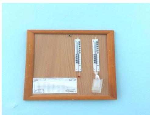
Рис. 2 - Вариант проекта по конструированию психрометра
